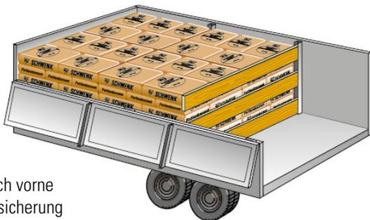
Formschluss nach vorne und seitlich. Absicherung nach hinten durch Klemmbretter.
