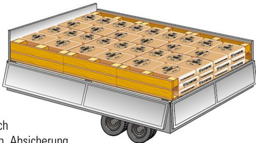
Formschluss nach vorne und hinten. Absicherung an den Seiten durch Paletten.
