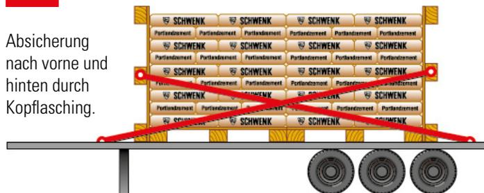
Absicherung nach vorne und hinten durch Kopflasching.
