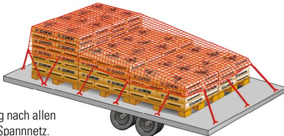
Absicherung nach allen Seiten mit Spannetz.
