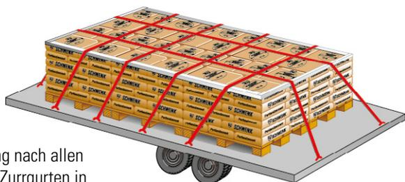
Absicherung nach allen Seiten mit Zurrgurten in Verbindung mit Schutz-Profilleisten.
