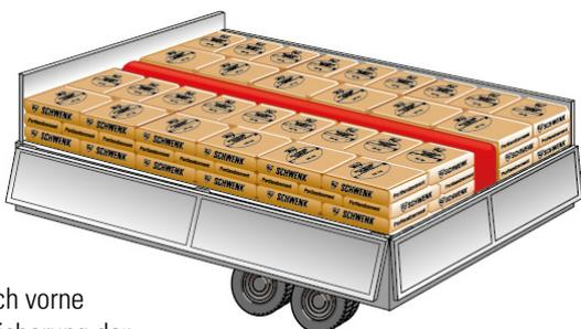
Formschluss nach vorne und hinten. Absicherung der Leerräume durch Luftkissen mittig.
