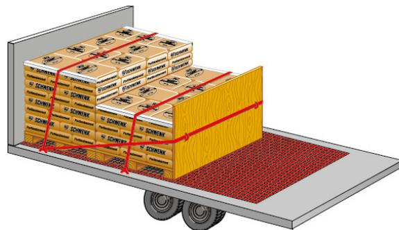
Formschluss nach vorne. Absicherung an den Seiten mit Zurrgurten in Verbindung mit Schutz-Profilleisten sowie Kopflasching nach hinten. Zusätzliche Fixierung durch Anti-Rutschmatte.
