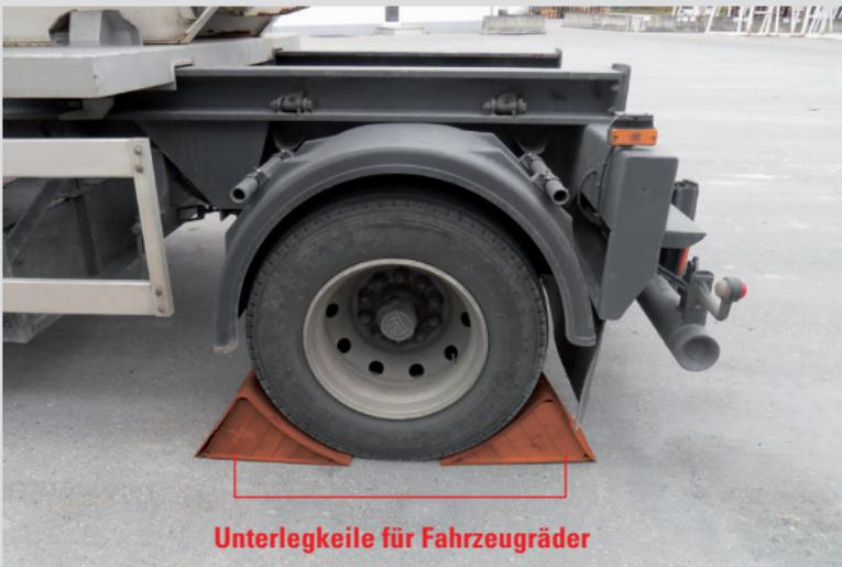
Unterlegkeile für Fahrzeugräder
